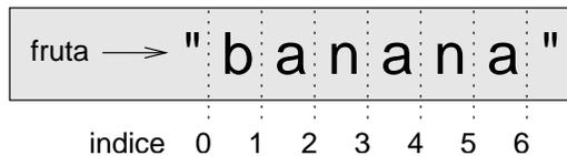
Si omite el primer índice (antes de los dos puntos), la porción comienza al principio de la cadena. Si omite el segundo índice, la porción llega al final de la cadena. Así:
