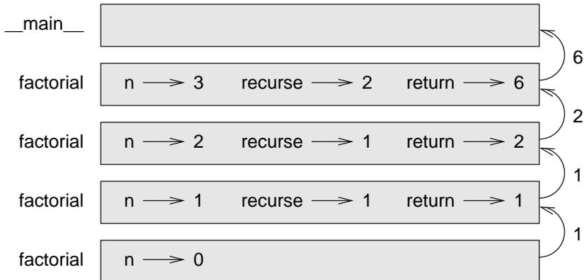
Los valores de retorno se muestran según se pasan hacia la parte superior de la pila. En cada marco, el valor de retorno es el valor de **resultado**, que es el producto de  $n$  por **recursivo**.
