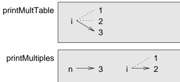
El valor de `i` en `imprimeTablaMult` va desde 1 hasta 6. En el diagrama, resulta ser 3. El próximo recorrido del bucle será 4. En cada recorrido del bucle, `imprimeTablaMult` llama a `imprimeMultiplos` con el valor actual de `i` como argumento. Ese valor se asigna al parámetro `n`.
