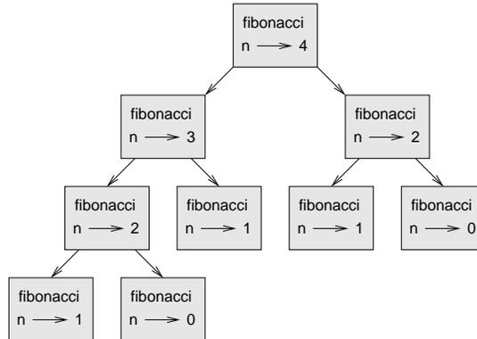
Un gráfico de llamadas muestra un conjunto de cajas de función con líneas que conectan cada caja con las cajas de las funciones a las que llama. En lo alto del gráfico, `fibonacci` con `n=4` llama a `fibonacci` con `n=3` y `n=2`. A su vez, `fibonacci` con `n=3` llama a `fibonacci` con `n=2` y `n=1`. Y así sucesivamente.
